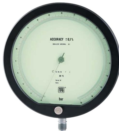
Strumenti realizzati per essere impiegati come manometri di controllo o di ricalibrazione e in altre applicazioni dove la precisione e la ripetibilità sono elementi molto importanti. I fluidi di processo devono essere liquidi o gas che non aggrediscono le leghe di rame e che non presentano una viscosità elevata e che non cristallizzano. Su richiesta sono corredati di certificati di taratura rilasciati da un laboratorio accreditato da ACCREDIA (Ex SIT: Servizio Italiano Taratura).
